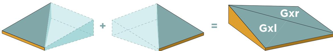
**Exemple d'un plan d'isolation en pente intégrée**
